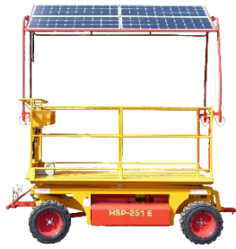
Dak met zonnepanelen Voor extra laadcapaciteit
